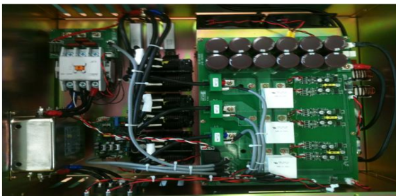
그림 2. 15kW급 충방전기용 PWM Converter의 내부구성
