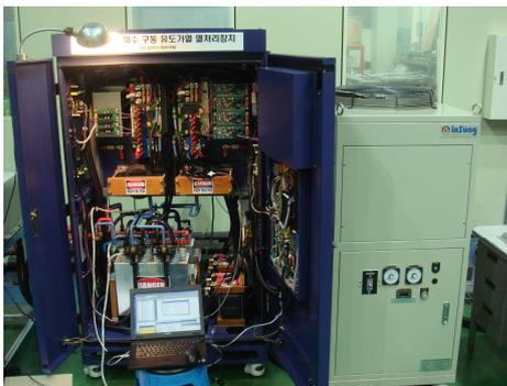
그림 6 SDF 인버터 유도가열 장치
