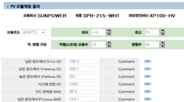
그림 3 PV Array Sizing Tool을 이용한 모듈 매칭 결과 Fig. 3 Module Matching Result using PV Array Sizing Tool
