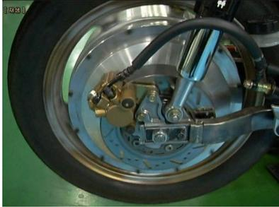
그림 2 전기이륜차용 IPMSM의 외관 모습
