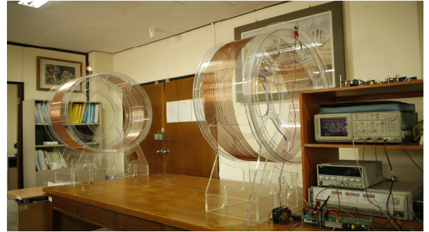
그림 5 무선전력전송 ECR 장치(60W 전구 점등) Fig. 5 ECR device for wireless power transfer(60W light-bulb)
