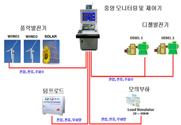
그림 1 하이브리드 발전시스템 구성도 Fig 1. Configuration of hybrid generation system
