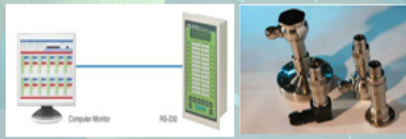
그림 15. 온도감시장치 및 온도센서의 예
