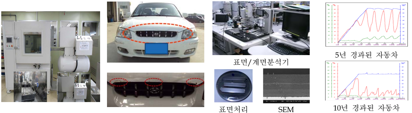
• 멀티싱글 칩핑시험기 (국내유일) • 자동차 중고차 분석 • 표면 계면 접착력 분석과정 • 시간에 따른 표면/계면 접착력 그림 1. 자동차 도금·도장 부품소재 내칩핑성 평가를 위한 여러 분석방법
