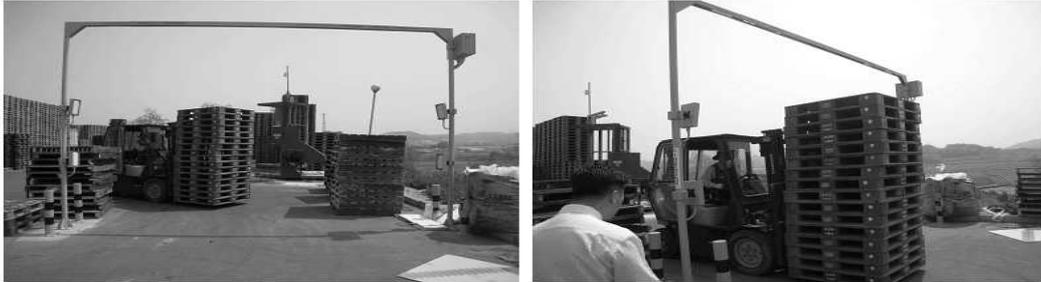
[그림 7] RFID Tag Pallet 인식률 측정 (입·출고게이트)
