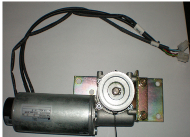
〈그림 2〉 DCU에 사용된 BLDC 모터 사진
