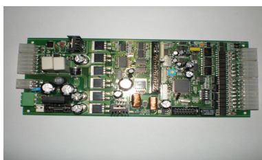
〈그림 3〉 제작되어진 DCU 시제품의 외형 및 주회로
