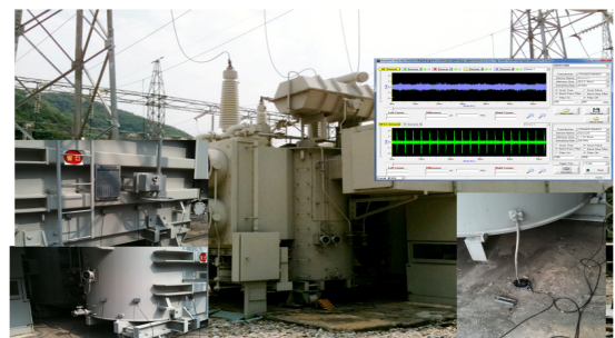
〈그림 2〉 유입식변압기의 부분방전진단 (소양강 수력발전소 1호기 Main TR, 2010.08.13)
