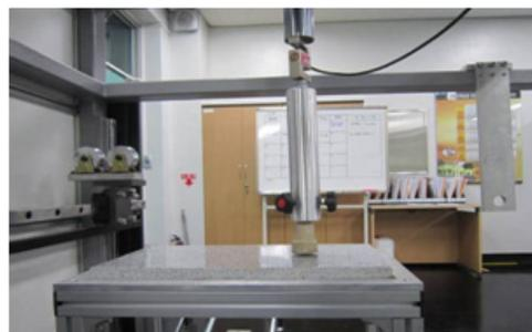
〈그림 2〉 미끄럼저항 시험 과정
