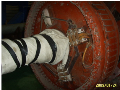
〈그림 5〉 회전자 몸체 및 계자접속부 노후상태
