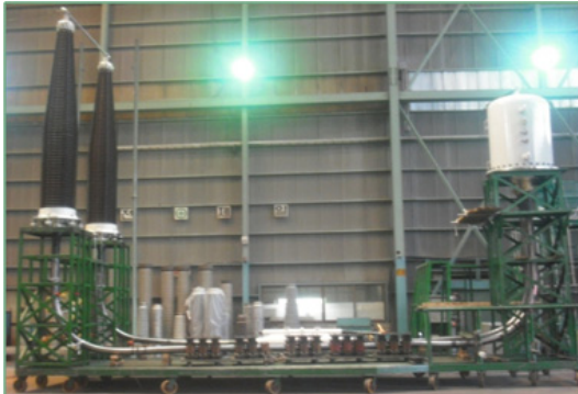
〈그림 8〉 400kV XLPE 2500SQ 소선절연 접속재 Type Test 회로
