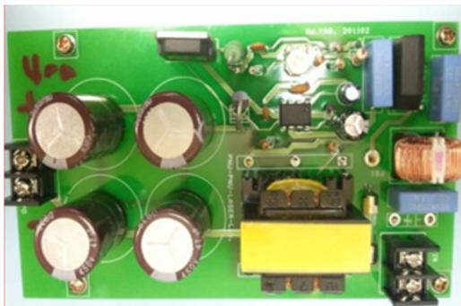
〈그림 5〉 실제 제작된 펄스형 Nd:YAG 레이저 SMPS 전원 장치
