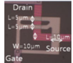
<그림 1> f-모양 트리플게이트 박막트랜지스터의 단면도 및 평면도
