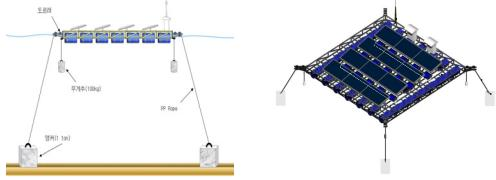
〈그림 1〉 수상 태양광발전 시스템 개념도
