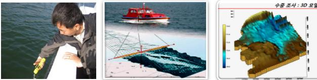
**<그림 5> 수심측정기 및 GPS기기를 활용한 현장 수심 측정**
