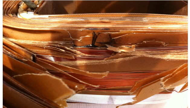
〈그림 8〉 뇌임펄스 시험을 진행한 변압기 내부 권선
