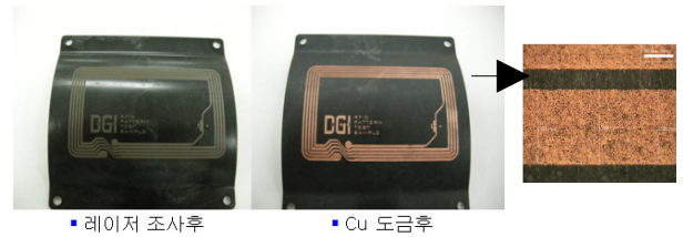
〈그림 9〉 레이저조사제어에 따른 RFID 전도성패턴 특성샘플
