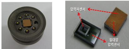
〈그림 2〉 GIS용 압력파 센서(좌), 압력/압력파 융복합 센서(우)
