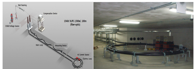
<그림 6> PQ Test 회로도 및 현장설비
