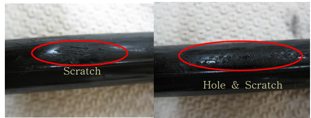
〈그림 3〉 전선 외피상의 scratch and micro hole
