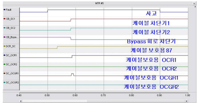
〈그림 8〉 Scenario 4(1선 지락) : 계전기 및 차단기 동작
