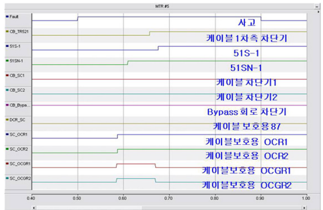
〈그림 10〉 Scenario 4(1선 지락) : 계전기 및 차단기 동작
