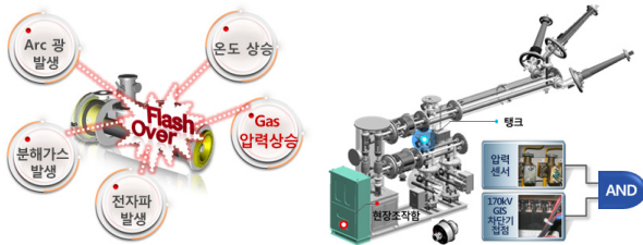
〈그림 1〉 170kV GIS 고장구간 판정시스템
