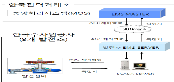
<그림 1> 수력발전소 자동발전제어(AGC) 운전 시스템
