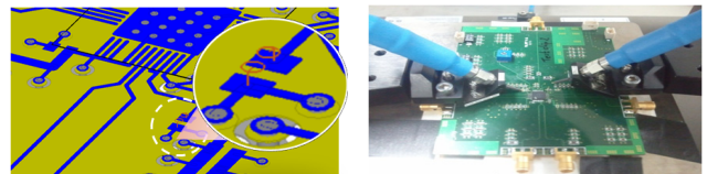
a) Power/Ground plane의 Full-wave Simulation 및 Impedance 측정
