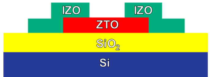
<그림 1> 제작된 산화물 박막 트랜지스터의 구조
