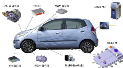
〈그림 1〉 전기자동차의 주요부품 (현대BlueOn모델) [1]
