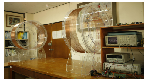
<그림 6> Class \Phi_2 공진형 인버터 모듈을 이용한 무선전력전송
