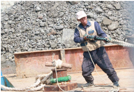
Fig. 4 부선의 예인줄 결속 작업 동작
