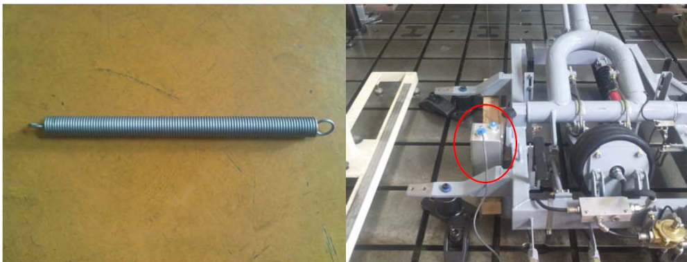
그림 7. 시험에 사용된 스프링 및 변위계
