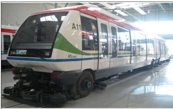
그림 1. 의정부 경전철 VAL 208 차량시스템
