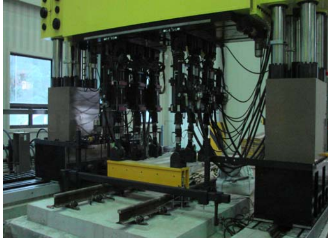
그림 10. 하중재하 장치를 이용한 재하-제하 시험 전경
