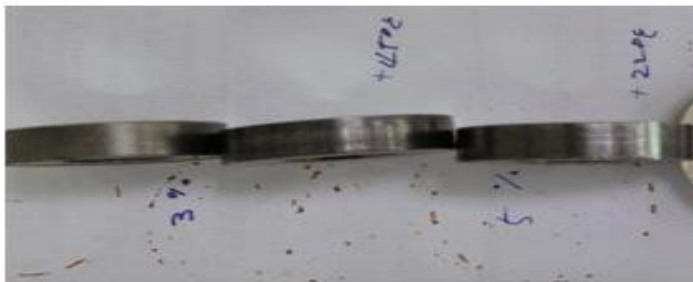
그림 11. Rolling contact damage of specimen before and after test
