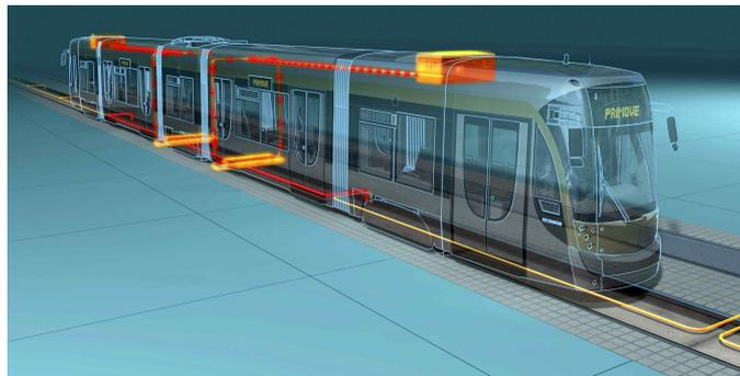
그림 2-1 Bombardier사의 PRIMOVE 경량전철 시스템
