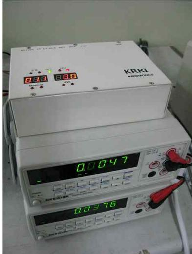
그림 2-9 공진형 인버터 dc-link 전압, 전류 계측기(효율 측정용)
