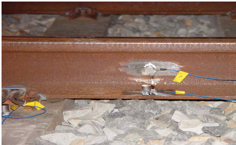
그림 3 자갈궤도의 레일과 침목의 진동 측정
