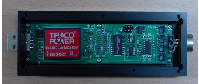
그림 5. 4-channel data acquisition module.
