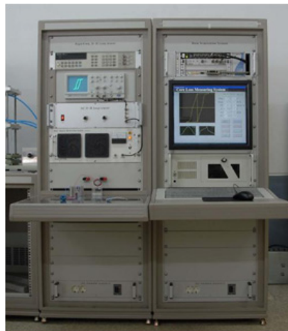
그림 2. 고주파 AC B-H loop 측정장치
