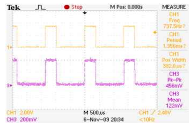
(b) 통류율 25[%] 일 때 PWM 파형 그림 3-1 PWM파형의 예 (계속)
