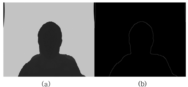
그림 5. (a) 업샘플링된 깊이 정보 (b) Canny 연산자를 이용하여 추출된 깊이 영상의 경계
