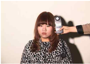
그림 21. 조도와 색온도 측정 - LED Spot 144[W] Fig. 21. Illumination and color temperature measurement - LED Spot 144[W]
