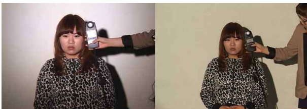
그림 22. 조도와 색온도 측정 - LED Zoom Spot 100[W], 200[W] Fig. 22. Illumination and color temperature measurement - LED Zoom Spot 100[W], 200[W]
