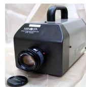
그림 12. MINOLTA사의 분광반사휘도계 CS-1000 Fig. 12. Spectral Reflectance luminance meter (MINOLTA CS-1000)(Measurement device)
