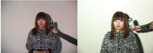
그림 20. 조도와 색온도 측정 - Arri 650[W], 1000[W] Fig. 20. Illumination and color temperature measurement - Arri 650[W], 1000[W]
