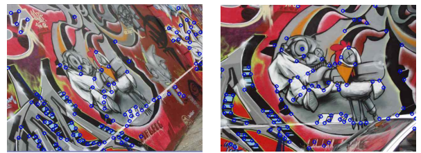
(c) graffiti 원본 영상 헤리스 코너 검출기 특징점 추출 (d) graffiti 질의 영상 헤리스 코너 검출기 특징점 추출
