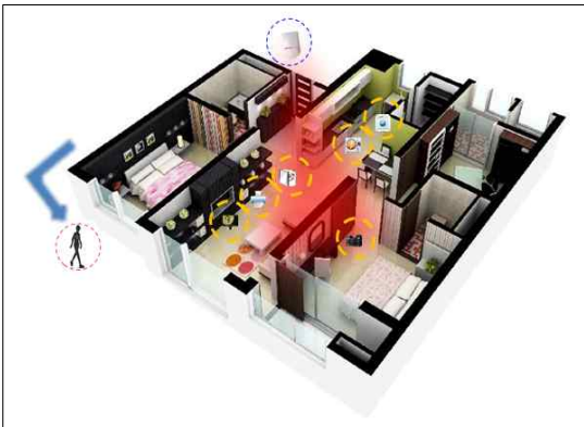
[그림 2] 재실센서에 의한 대기전력 제어 시스템
