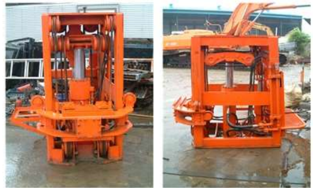
그림 5. P.B.D 리더 보조압입장치 실제 모습
