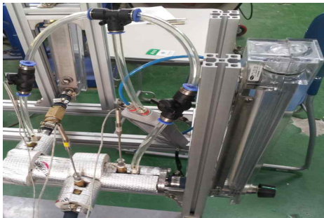
그림 5. 볼텍스 튜브 실험 장치.
