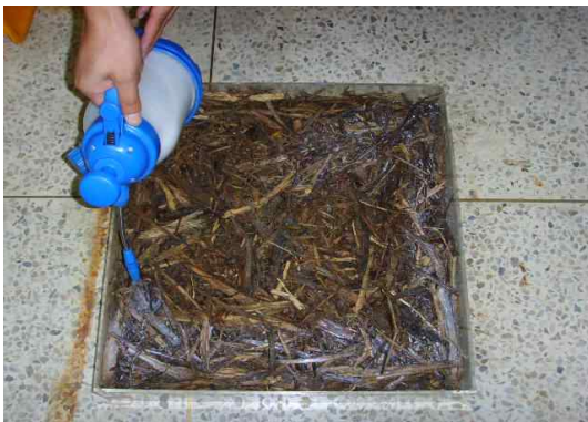
[그림 2] 시험 시편에 접착제 살포
