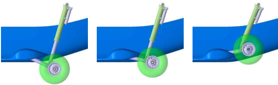
[그림 2] 주륜 착륙장치 추락 시 거동 예시
