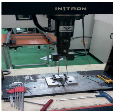
[그림 4] 점용접부의 신뢰성 시험(Peel-off test)
