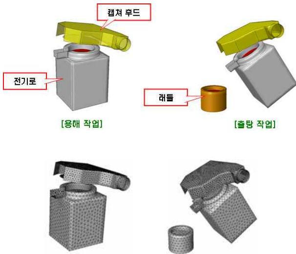
[그림 2] 수치 해석용 직인식 후드 모델링 및 격자 형상화 모습
