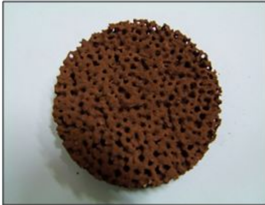
Fig. 1 NiFe 2 O 4 /m-ZrO 2 /MPSZ foam device
